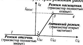
Рис. 13. Режимы работы транзистора
